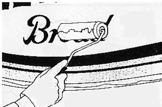
7. Der Folienentferner muss mindestens 5 – 10 Minuten einwirken. Die Einwirkzeit erhöht sich bei kühleren Temperaturen.
